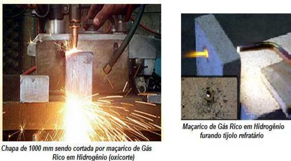
Figura 20 – (a) Chama de Gás Rico em Hidrogênio Realizando Oxicorte e (b) Chama de Gás Rico em Hidrogênio Furando Tijolo Refratário (Alkem Eq. Industriais Ltda, 2013).
