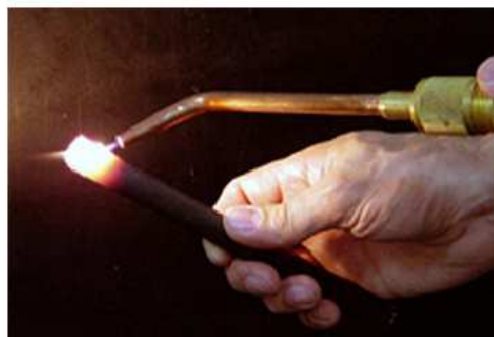
Mesma Chama aquecendo uma barra circular de liga metálica
