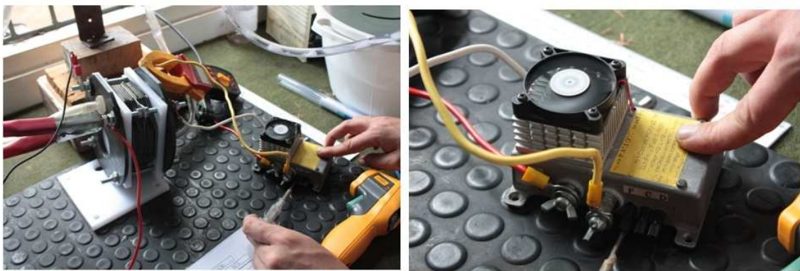
Figura 90 – CCPWM Utilizado nos Ensaaios de Bancada
