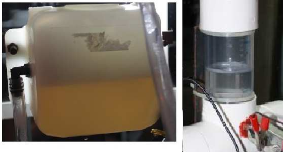
Figura 94 – Coloração da Solução após Ensaio - Eletrodos de Aço 304 x Eletrodos de Aço 316L
