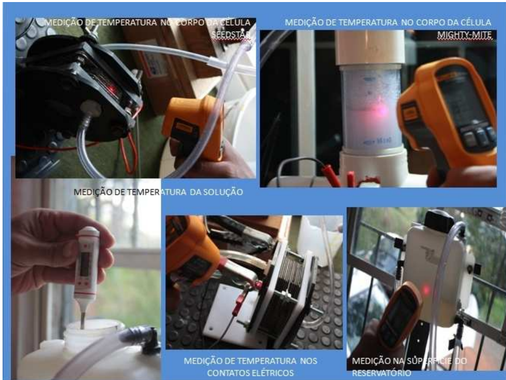
Figura 65 – Tomadas de Temperatura do Sistema
