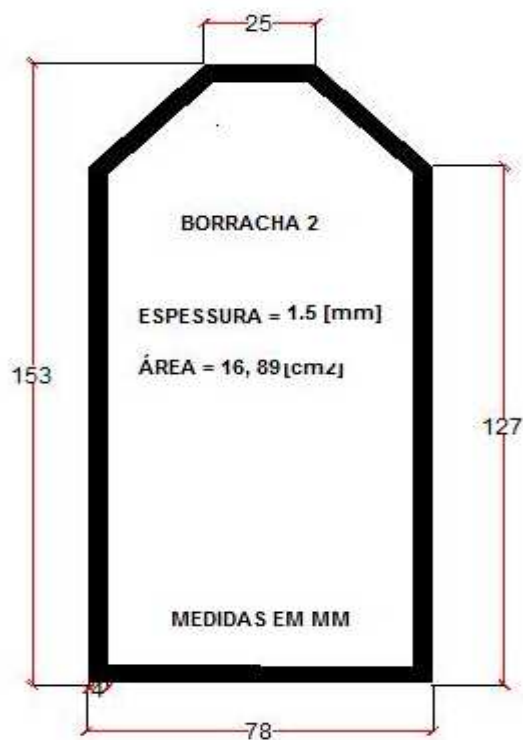
Figura 49 –Borracha da Célula NanoStar. Medidas em [mm].
