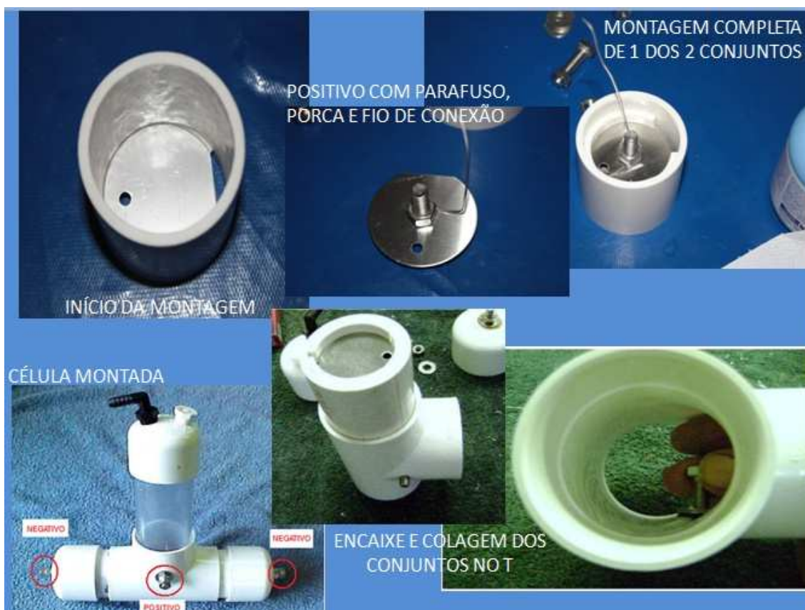
Figura 58 –Etapas de Montagem da Célula Mighty-Mite.
