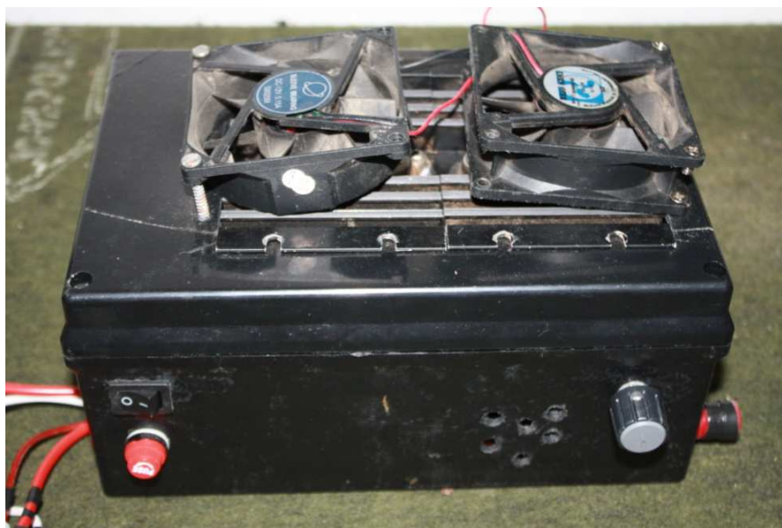
Figura 28 – Fonte de Tensão Regulável utilizada para Alimentação Elétrica do Sistema.
