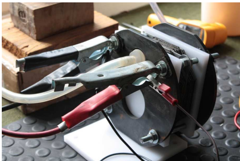
Figura 44–Célula SeedStar Conf. B3 com os eletrodos conectados à bateria do Gol CHT 1.0
