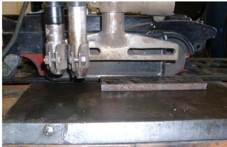
Figura 3.3 – Ajuste das tochas para o processo DW.
