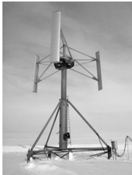
Figura 1.7: Turbina Darrieus H Fonte: Czecoski (2015)
