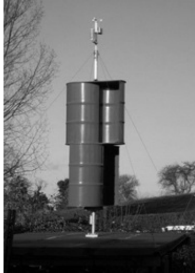
Figura 1.8: Turbina Savonius com duas conchas Fonte: Czeoski (2015)
