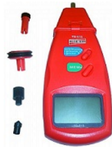
Figura 3.10: Tacômetro portátil TD-813
