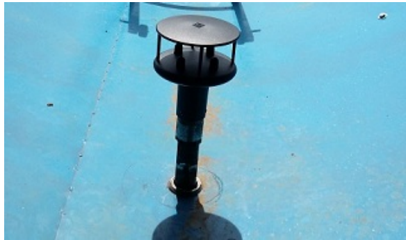
Figura 3.7: Sensor de velocidade do ar em escoamento
