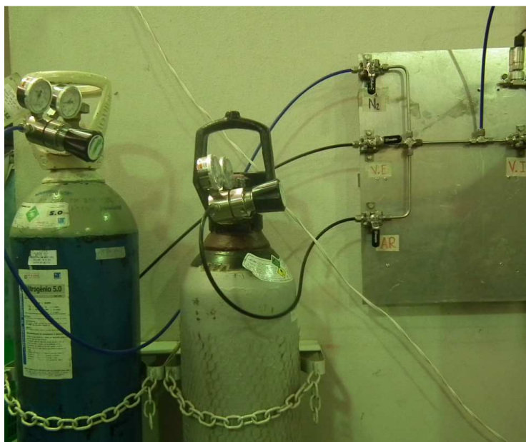
Figura 3.4. Sistema de fornecimento de gases
