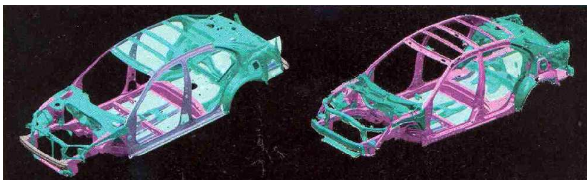
Figura 1 – Comparativo do aumento da utilização dos aços bifásicos no Honda Civic (KUVIN, 2007).
