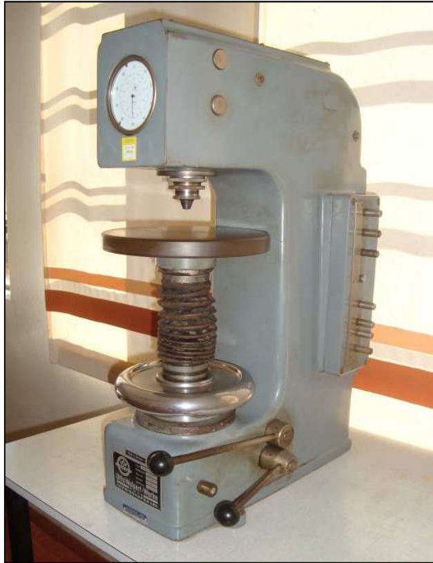
Figura 19 – Durômetro da marca Ottowolpert-Werke modelo Testor, presente no laboratório de metalografia da UNIFEL.
