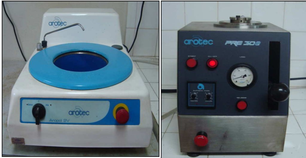
Figura 16 – Lixadeira/ politriz e embutidora utilizadas, ambas da marca Arotec, presente no laboratório de metalografia da UNIFEI.
