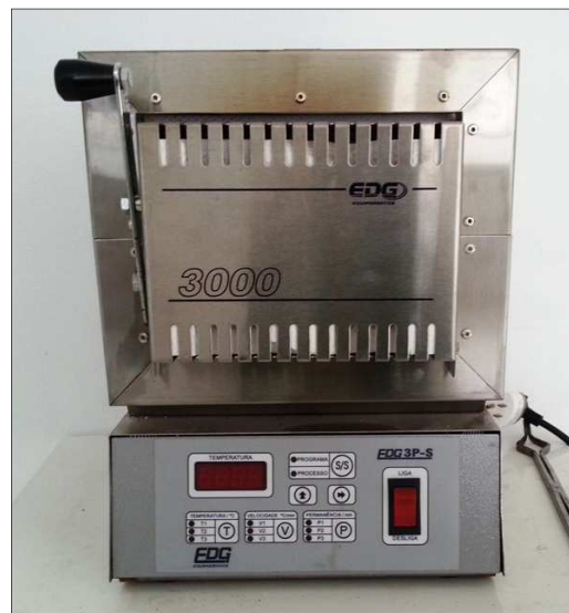
Figura 15 – Forno marca EDG modelo 3000 utilizado nos tratamentos térmicos, presente no laboratório de metalografia da UNIFEI.
