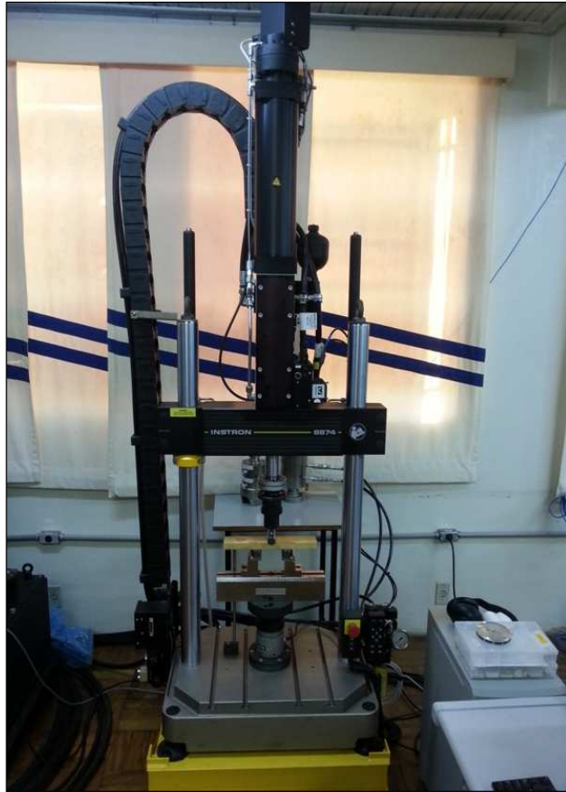
Figura 21 – Máquina para ensaio de tração da marca Instron modelo 8874, presente no laboratório de ensaios mecânicos da UNIFEI.
