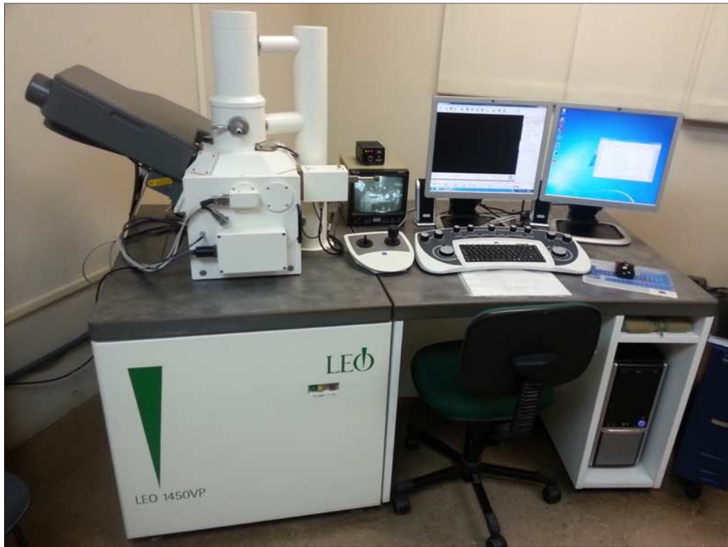
Figura 18 – MEV da marca Carl Zeiss modelo LEO 1450 VP instalado no laboratório de microscopia da USP/EEL.
