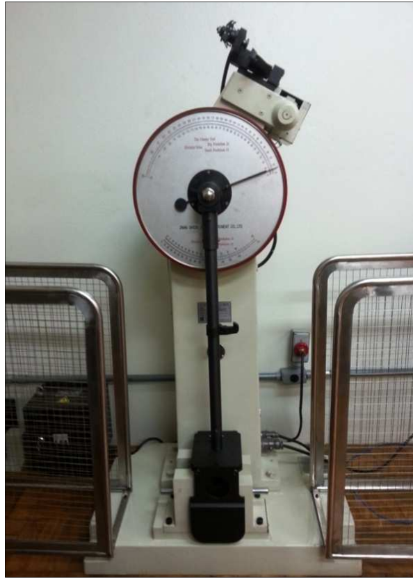
Figura 20 – Máquina de ensaio de impacto do tipo Charpy da marca Jinan Shidai Xinguang Instruments, presente no laboratório de ensaios mecânicos da UNIFEI.
