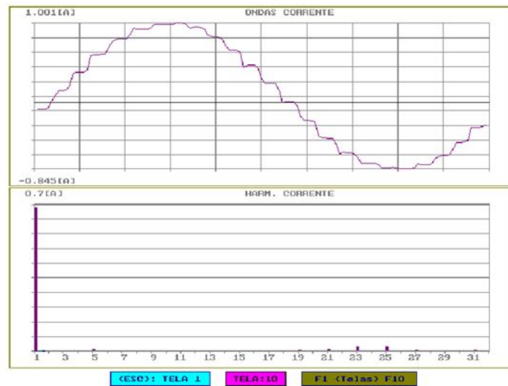
Figura 2 – Forma de onda e o espectro harmônico da corrente de linha de um sistema conversor de 24 pulsos.
