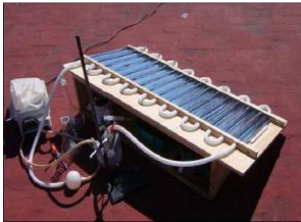
Figura 10 - Reator concentrador parabólico (CPC) com vazão de 1,2 \text{ L min}^{-1}
