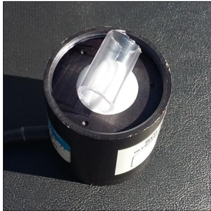
Figura 13 - Sensor UV-A do radiômetro com um pedaço da própria mangueira do reator simulando a energia recebida pelo efluente
