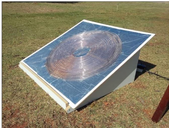
Figura 11 - Fotorreator para tratamento de efluentes têxteis após montagem
