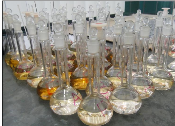
Figura 3.15: Óleo extraído de emulsões com diferentes concentrações. (A diferença de coloração se deve a variação de concentração de cada balão).
