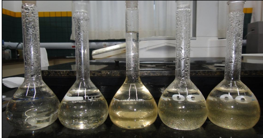
Figura 3.13: Amostra com triclorometano durante a fase de extração do óleo.
