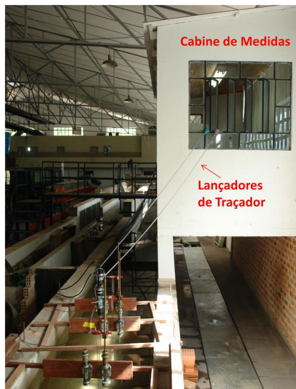
Figura 28 - Cabine de Medidas e Lançadores de Traçador.
