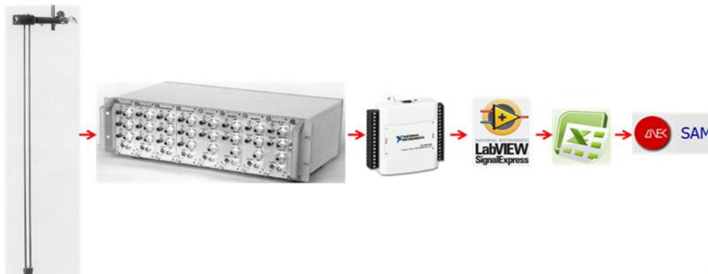
Figura 20 – Esquema da instrumentação utilizada (sondas resistivas).
