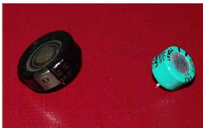
Figura 3.4 – Supercapacitor do tipo ficha ou laminado (round)
