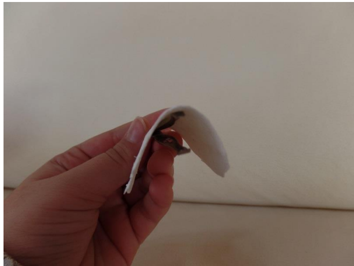
Figura 24: Fotografia da membrana de colágeno/HAp após realizar curvatura de aproximadamente 45° com auxílio de uma pinça. Note a membrana manteve a curvatura e não retornou a posição original.
