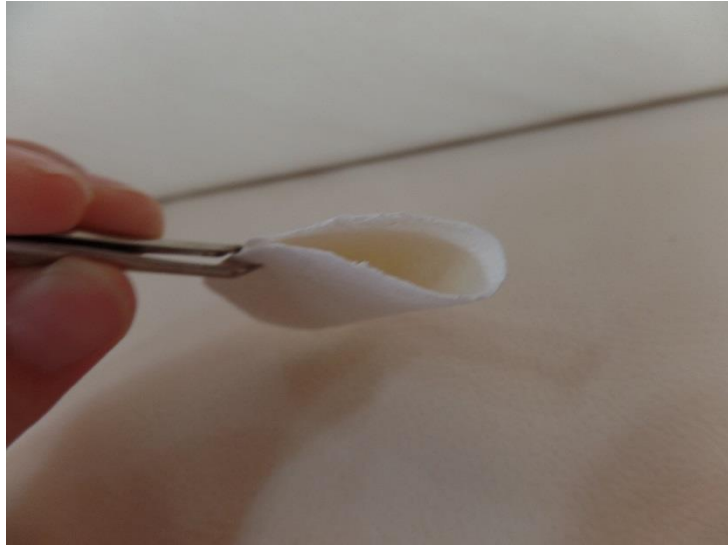
Figura 24: Fotografia da membrana de colágeno/HAp sendo curvada a 180° com auxílio de uma pinça. Note que a superfície curvada se manteve intacta, não foi observada rachaduras ou outras falhas na superfície da mesma.
