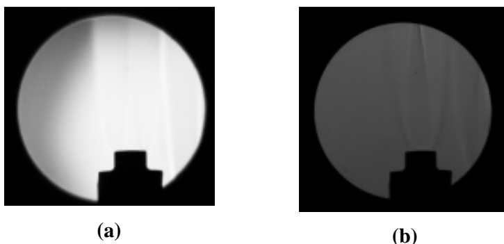
Figura 3-6 - Prova de conceito com queimador de diâmetro interno de 6mm e 400 mm de comprimento. (a). Chama difusiva (b) Deslocamento de chama.
