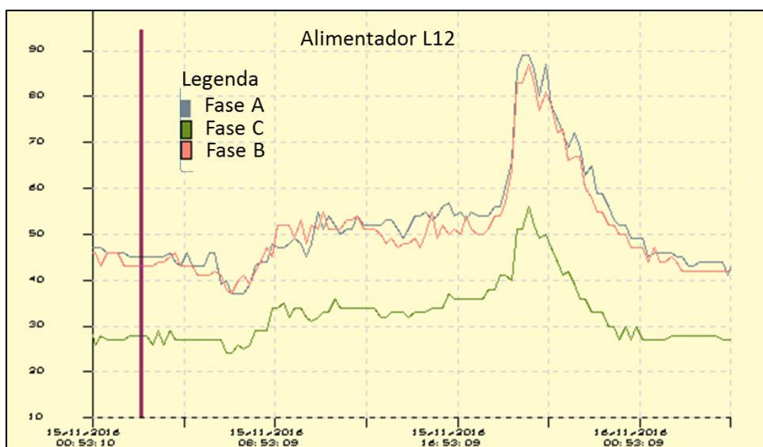
Figura 5-9 - Medição na saída do alimentador L12. Fonte: Sistema de supervisão e controle.
