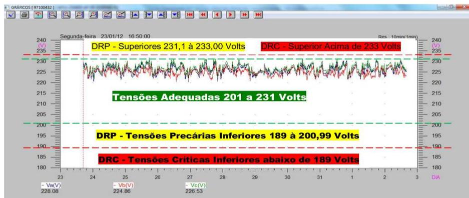
Figura 2.2: Gráfico de Tensão com tensão adequada
