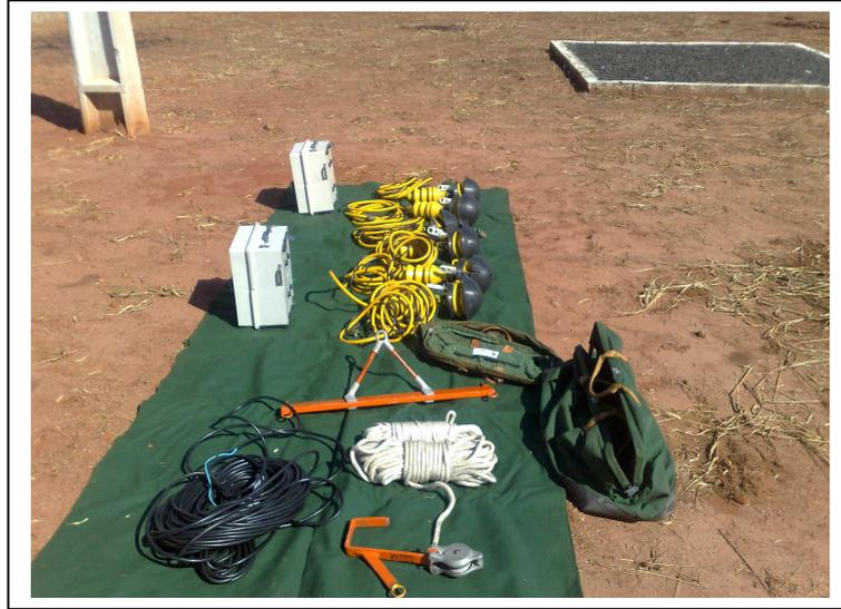
Figura 3.6 - Equipamentos para medição na média tensão
