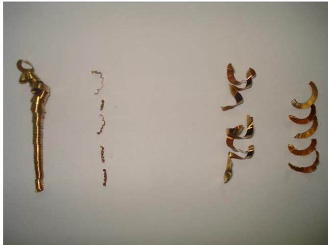
Figura 5.21- Tipos de cavacos gerados no torneamento do Bronze de Alumínio
