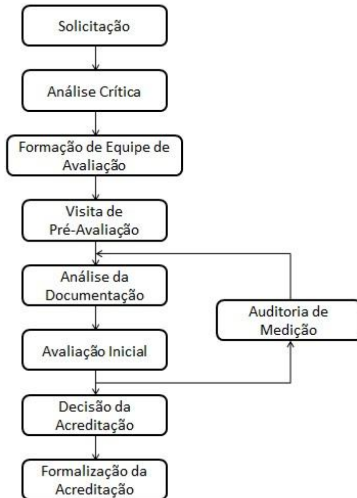
Figura 3.2: Fluxograma da Etapa de Fluxo Operacional do INMETRO (Extraído do site do INMETRO: www.inmetro.gov.br/credenciamento/acre_lab.asp ).
