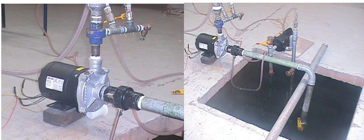
Figura 4.4: Vista da bomba succionando água do tanque submerso e anéis piezométricos para instalação dos medidores de pressão.
