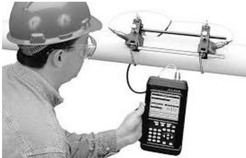
Figura 21 - Medidor acústico externo com uma trajetória - "Clamp On"
