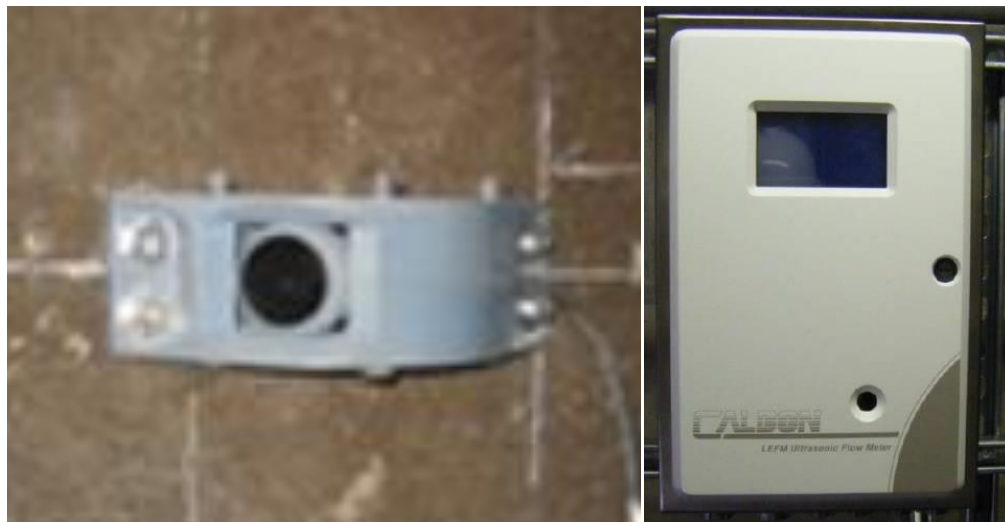
Figura 37 - Transdutores omnidirecional do tipo “Eyeball” CaldonHydro™ - CAMERON e Medidor de vazão ultrassônico modelo LEFM® 880 Series – CAMERON.
