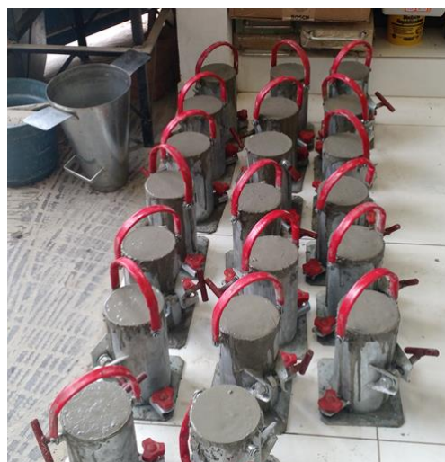
Figura 26 - a) Vibrador portátil e mangote, b) Corpos de prova moldados em moldes cilíndricos
