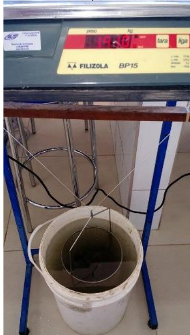
Figura 22 - Determinação da massa específica da brita com balança hidrostática
