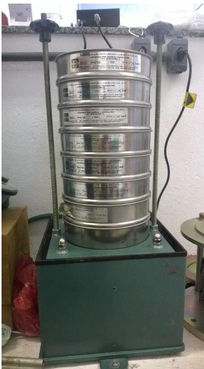
Figura 14 - Sequência de peneiras para ensaio de granulometria para agregados miúdos
