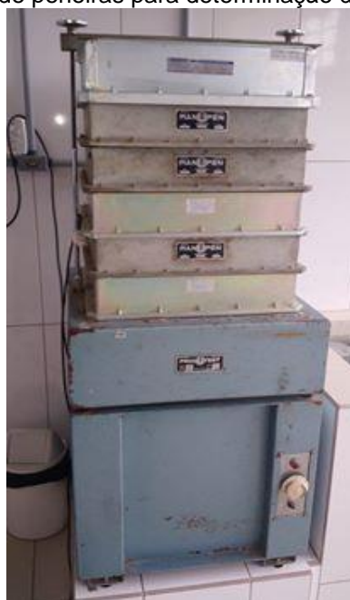
Figura 21 - Sequência de peneiras para determinação da granulometria da brita
