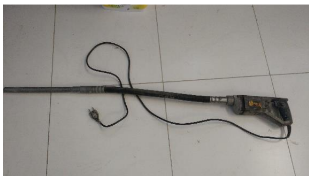
Figura 26 - a) Vibrador portátil e mangote, b) Corpos de prova moldados em moldes cilíndricos
