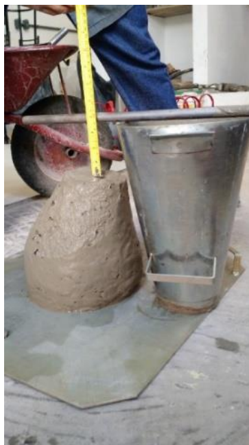
Figura 25 - Determinação do abatimento de concreto com tronco de cone metálico
