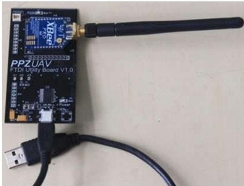
Figura 24 – Placa FTDI e modem de comunicação que são conectados à placa Raspberry Pi
