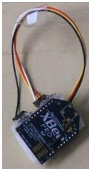
Figura 19 – Modem XBee Pro ZB com antena pequena embutida
