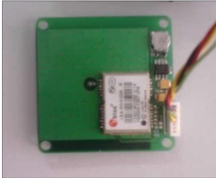
Figura 17 – GPS U-blox LEA 5S conectado no circuito principal
