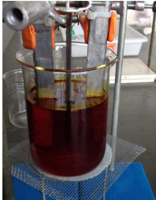
Figura 32 - Solução de ácido crômico com a amostra ao centro - Alumina ELFUSA Amostra MEV
