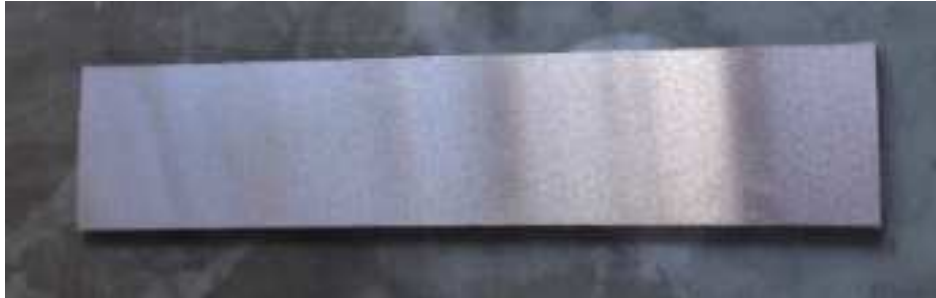
Figura 26 - Chapa de Aço SAE 1020 bruto após retificação acabamento espelhado com R_a=0,30\mu\text{m} e R_z=2,0\mu\text{m} - Imagem acabamento espelhado por retificação
