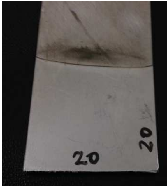
Figura 33 - Alumina ELFUSA - amostra com a camada de cromo aplicada
