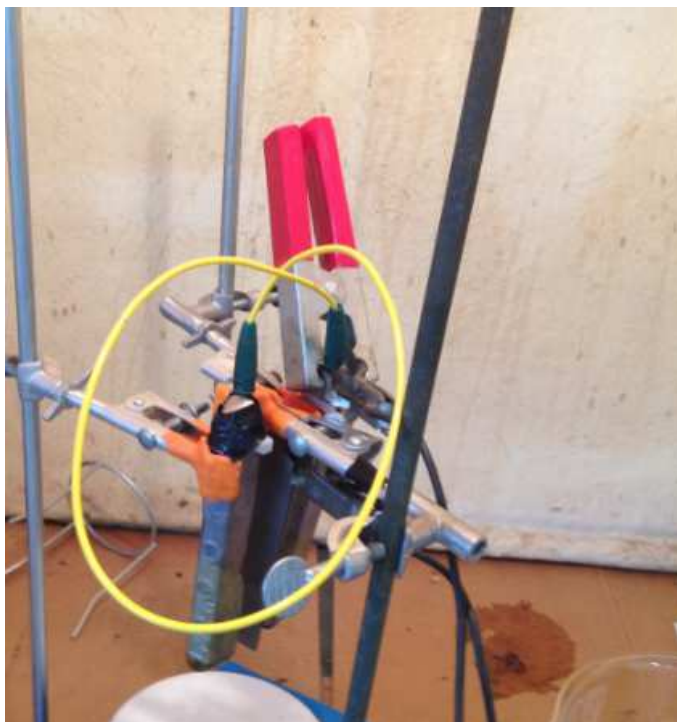
Figura 31 - Cabos elétrico de alimentação de corrente dos anodos e catodo - Ligação dos cabos de corrente
