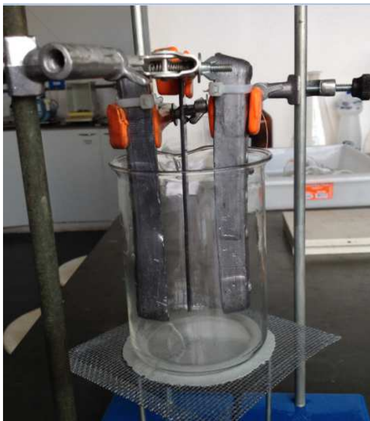
Figura 28 - Célula de Cromação com amostra ao centro - Montagem da célula de cromação
