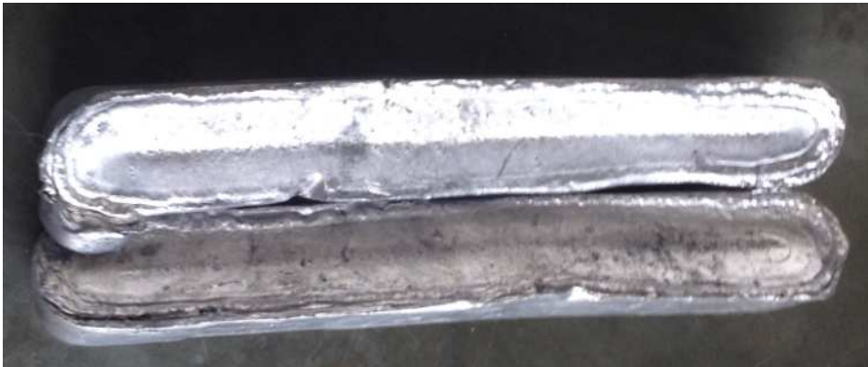
Figura 27 - Anodos de chumbo (93% Pb e 7% Sn). Dimensões de 200mmx30mmx10mm
