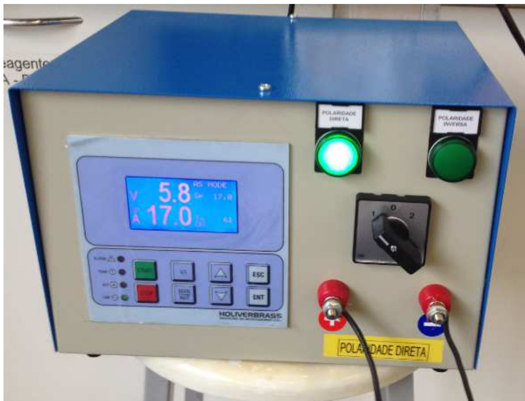
Figura 30 - Retificador de Corrente marca HOLIVERBRASS com inversão catódica - Retificador de Corrente com Inversão de polaridade
