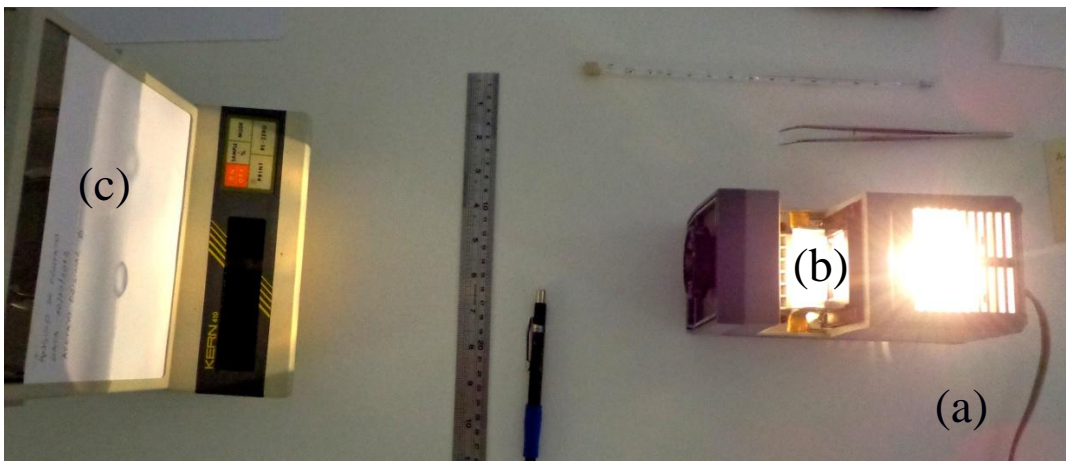
Figura 4.3: Sistema de medição do ângulo de contato “ home made ”: (a) projetor; (b) porta amostra; (c) anteparo.
