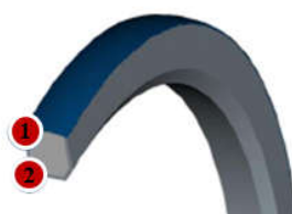
Figura 1 - Representação da camada de cromo no anel de pistão onde, (1) superfície de contato cromada e (2) substrato
