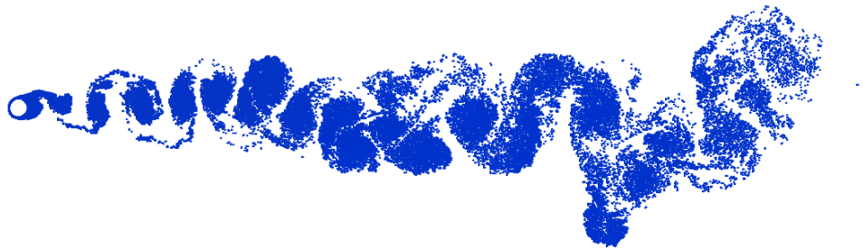
Figura 5.10 – Estrutura da esteira de vórtices para o tempo final t=50 do caso do cilindro circular sem efeitos de parede plana e sem troca de calor (MB=50, NV=50.000, \Delta t=0,05 , \sigma_0=eps=0,0090 , Re=10^5 )
