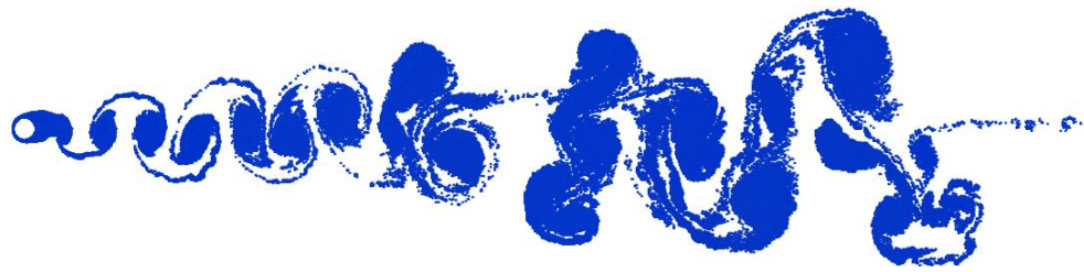
Figura 5.5 – Estrutura da esteira de vórtices para o tempo final t=50 do caso do cilindro circular sem efeitos de parede plana e sem troca de calor ( MB=300 , NV=300.000 , \Delta t=0,05 , \sigma_0=eps=0,0010 , Re=10^5 )
