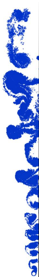
Figura 5.26 – Estrutura da esteira de vórtices para o tempo final t=75 do caso do cilindro circular com efeito de parede plana e sem troca de calor ( U_\infty = 0 ; V_\infty = 1 ; MB=100 , NV=150.000 , \Delta t=0,05 , \sigma_0=eps=0,0032 , Re=10^5 )
