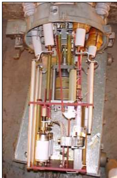
Figura 2.11 – Controle Hidráulico de um Religador Trifásico KF (CEMIG, 2007).
