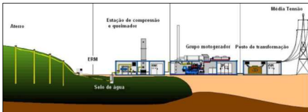
Figura 6.3 – Funcionamento de uma central de biogás para geração de energia elétrica (CREA-SC, 2017).
