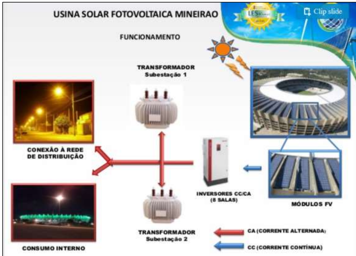
Figura 7.3 – Esquema de funcionamento da USF Mineirão (CEMIG, 2013).
