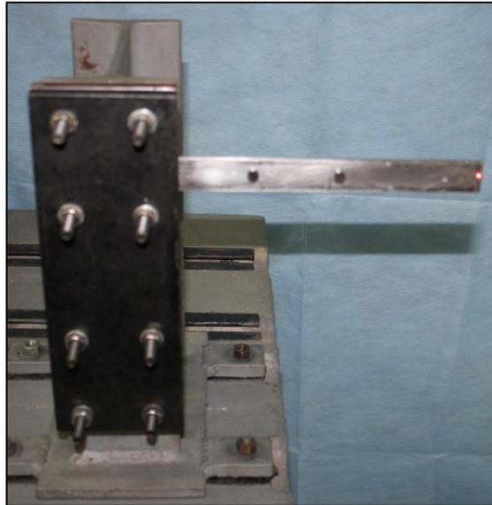
Figura 29 – Configuração do sistema com acréscimo de 2 ímãs.
