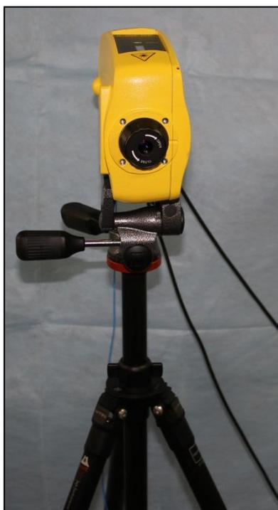
Figura 62 – Vibrômetro a laser.
