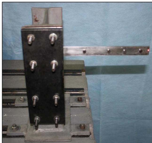
Figura 30 – Configuração do sistema com acréscimo de 4 ímãs.
