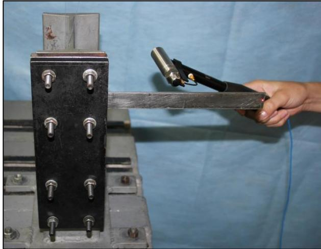
Figura 27 – Excitação da viga para obtenção da FRF.
