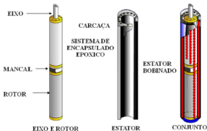
**Figura 3.3-** Principais componentes de um motor de indução de BCSS;
