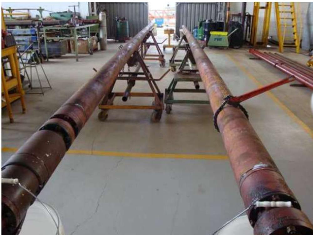
**Figura 3.1-** Fotografia de motores de BCS;
