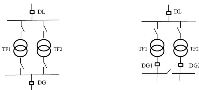
(a) Transformadores com chaves isoladoras manuais na AT e MT
