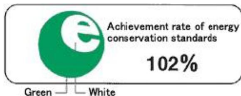
Figura 2.19 - Exemplo de selo energético japonês para um produto que já ultrapassou seu respectivo padrão de performance estabelecido pelo "Princípio do Melhor Corredor"
