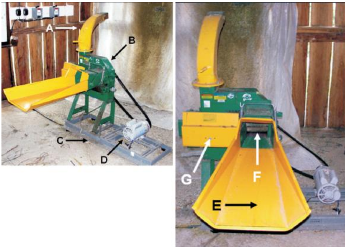
Figura 2.23 - Principais Componentes de uma Picadora de Forragem
