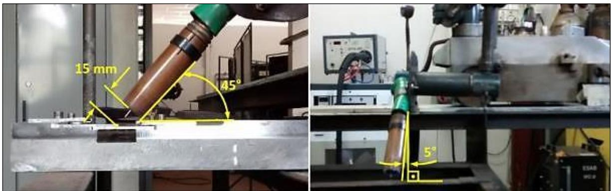
Figura 3.7 - Soldagem da junta sobreposta. Fonte: Autor (2016).
