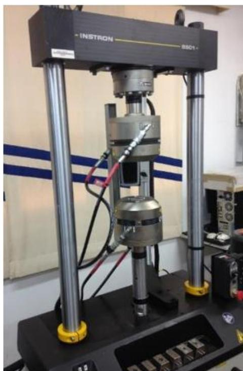
Figura 3.10 - Equipamento Instron 8801<sup>®</sup> para ensaios mecânicos dinâmico e estático. Fonte: Autor (2017).
