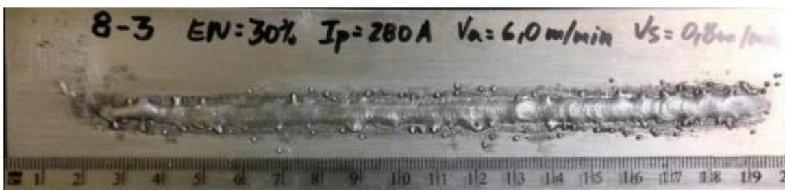
Figura 4.3 - Cordão de solda referente ao teste 8-3 conduzido usando  $I_p = 280$  A,  $V_a = 6$  m/min e  $EN = 30\%$ .
