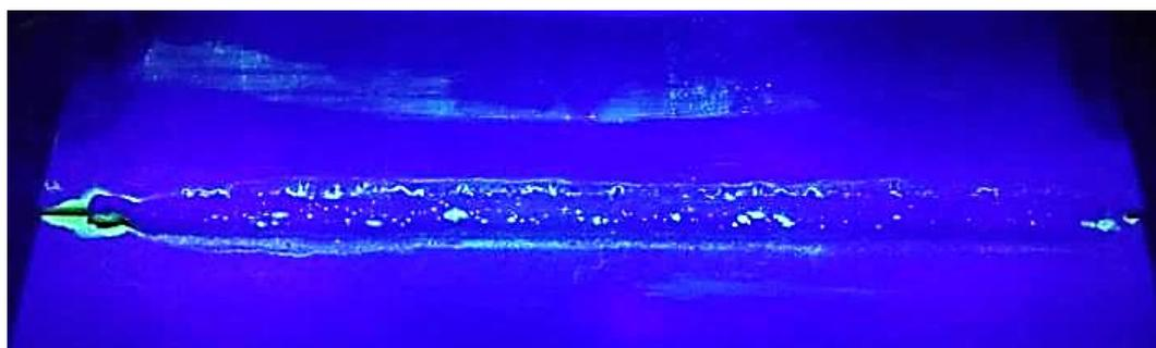
Figura 4.12 – Corpo de prova 11A ( $EN = 50\%$  e  $gap = 0$ ) submetido ao ensaio de líquido penetrante.
