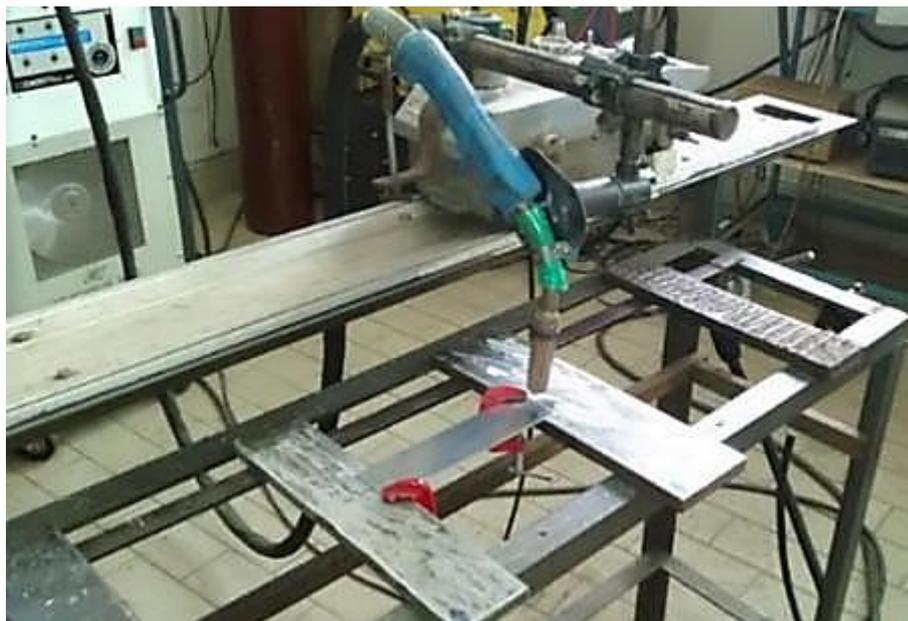
Figura 3.5 - Preparação dos CDP's para soldas de simples deposição. Fonte: Autor (2016).
