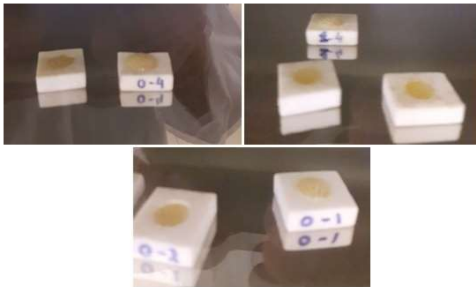
Figura 9 - Molde de teflon contendo as formulações de PU próprio autor.
