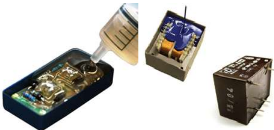
Figura 2 - Processo de encapsulamento de circuitos e componentes eletrônicos [19]
