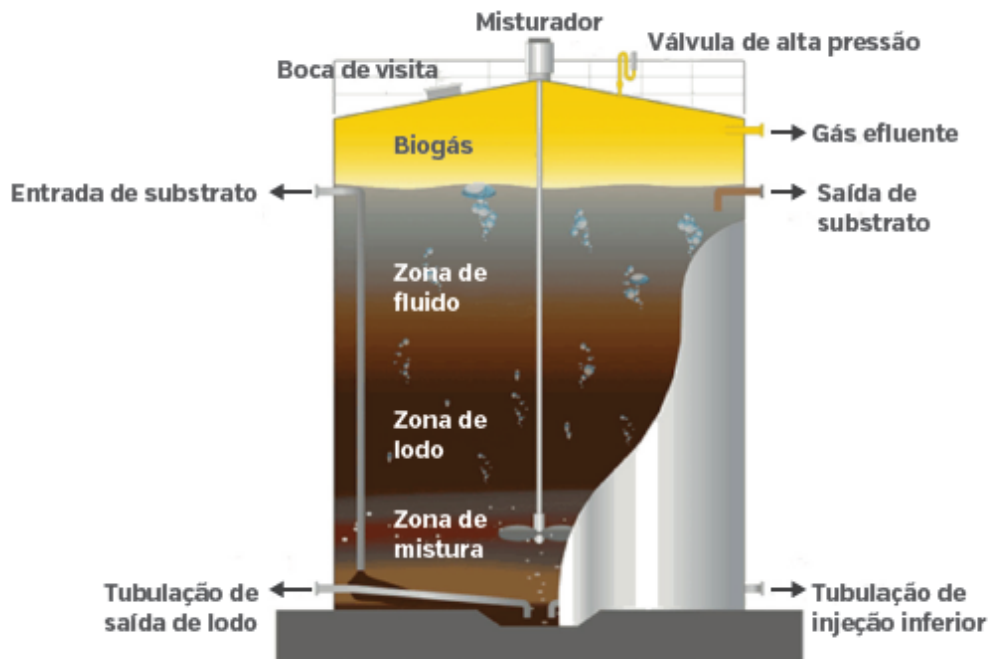
Figura 3.5 – Esquema de um digestor anaeróbio e lodo cilíndrico
