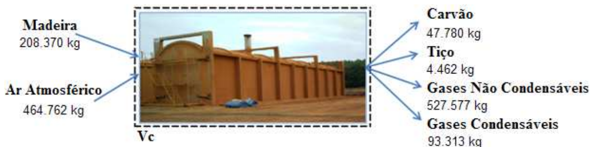
Figura 4.2. Resultados do balanço de massa para um forno retangular
