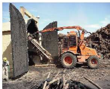
Figura 2.12. Exemplo de um Forno Retangular com carregamento mecânico (Almado, 2014; Santos, 2007).
