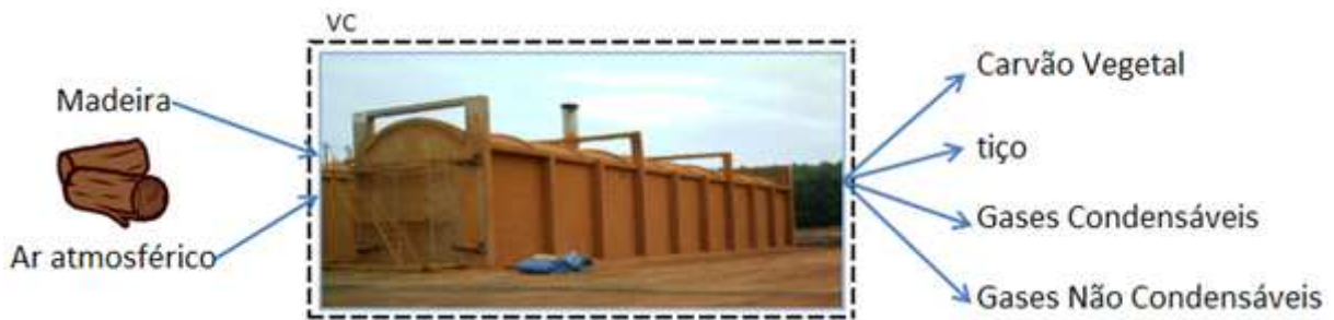
Figura 4.1. Fronteiras do Sistema utilizadas no Balanço de massa e energia.
