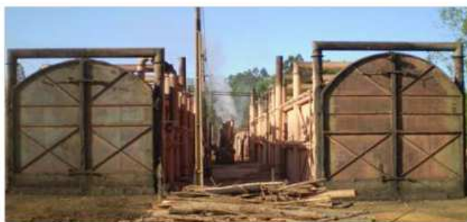
Figura 2.12. Exemplo de um Forno Retangular com carregamento mecânico (Almado, 2014; Santos, 2007).
