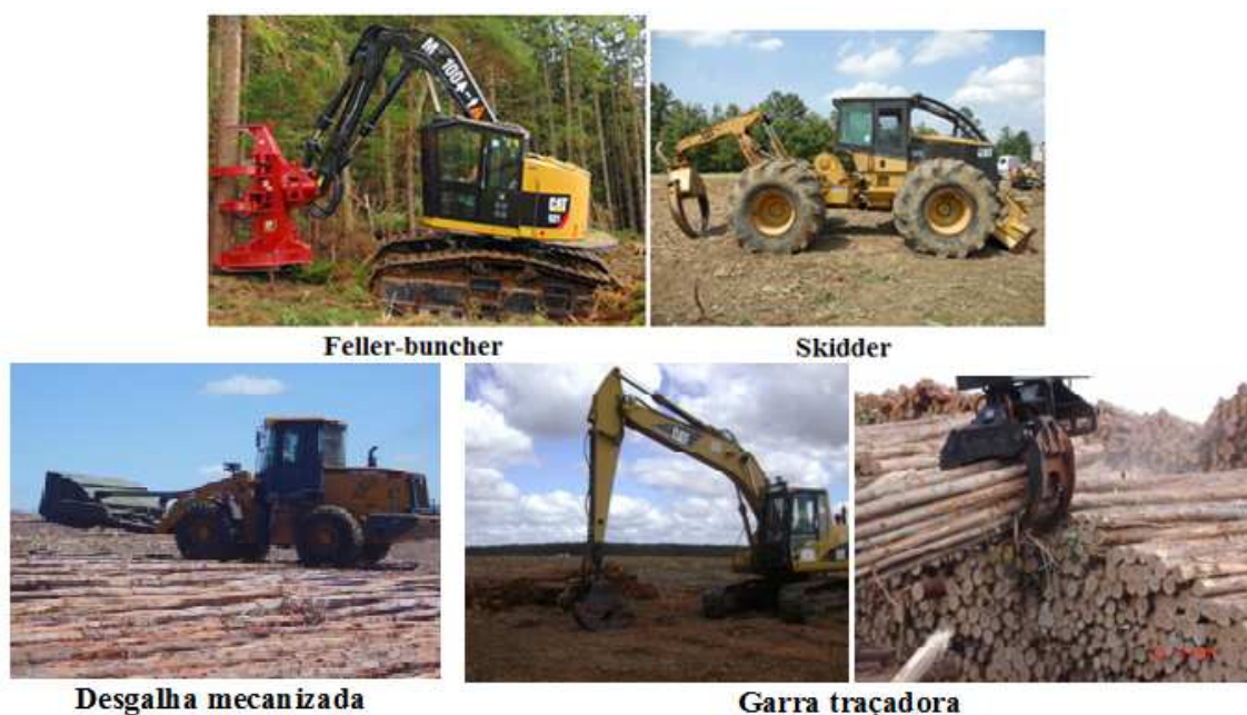
Figura 5.2. Maquinários utilizados na operação de corte da madeira
