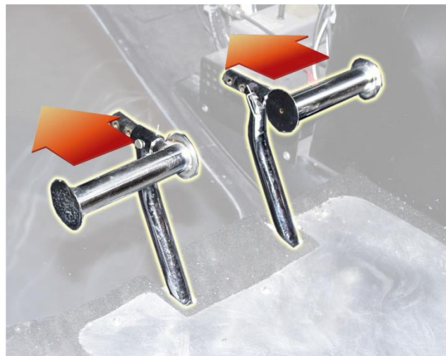
Figura 2.7 - Os pedais compensam o torque e controlam a direção do helicóptero.
