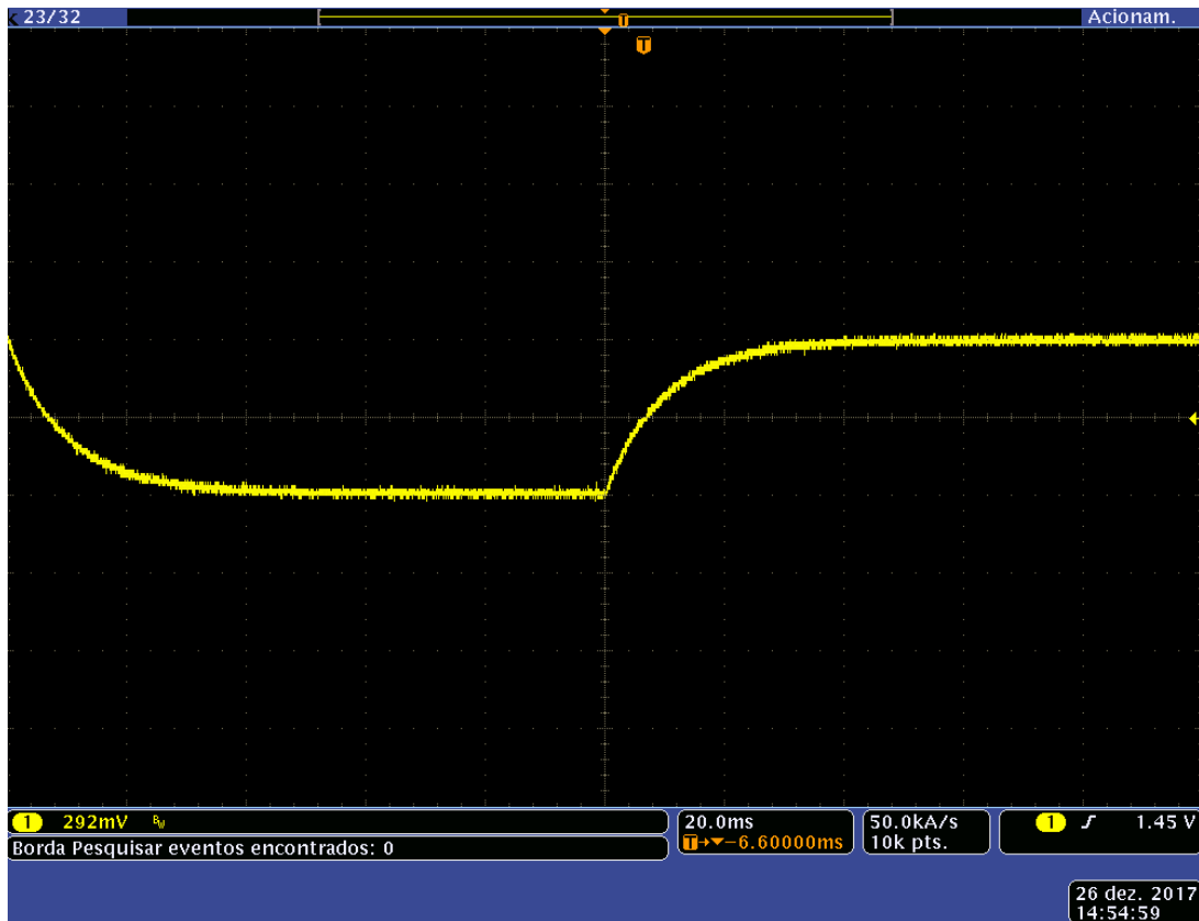
Figura 25 – Controle de tensão de um circuito RC em malha aberta
