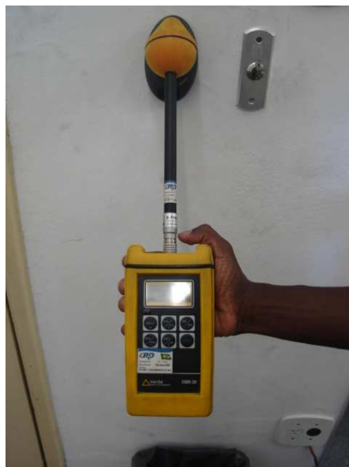
Figura 5.17 – Medição de um leitor comercial de identificação por radiofrequências. Observar que o produto sob teste está localizado atrás da sonda e foi encontrada a intensidade de campo magnético de 70mA/m.
