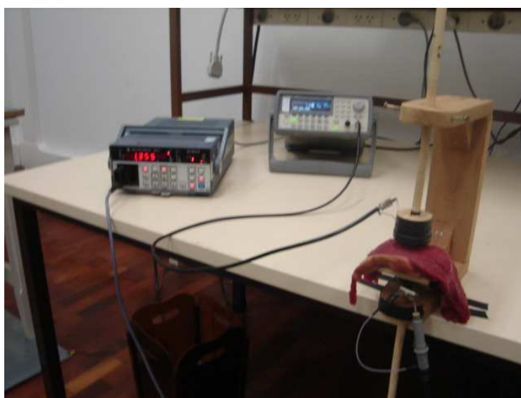
Figura 5.13 – Visão geral na medição com tecido bovino entre o leitor e alvo, destacando os diferentes equipamentos empregados em todas as medições.
