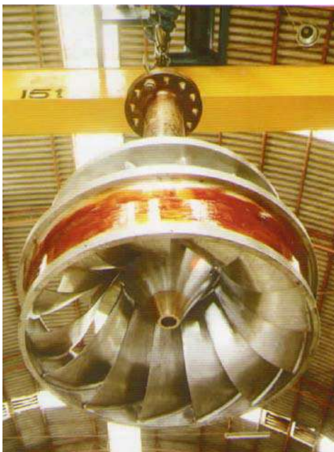
Fig. 3.14 Rotor Francis da UHE Eloy Chaves.
