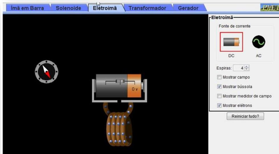
Figura 3.3 – Configuração do eletroímã (tensão elétrica nula).
