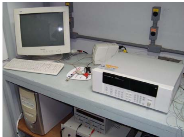
Figura 4.12: Aquisição Agilent 34980A e microcomputador, usados na medição das temperaturas.
