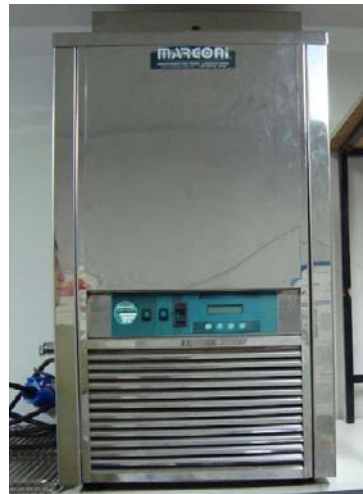
Figura 4.11: Banho termostático Marconi MA 184, usado para calibrar os termopares.
