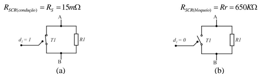
Figura 3.11 – Condição do SCR paralelo ao resistor da carga: (a) SCR  $T_1$  como interruptor fechado, (b) SCR  $T_1$  como interruptor aberto.
