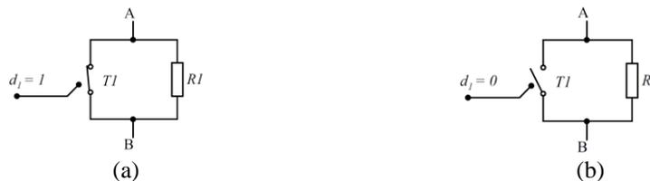
Figura 3.12 – SCR em condução e em bloqueio: (a) SCR em condução com  $d_i = 1$ , (b) SCR em bloqueio com  $d_i = 0$ .
