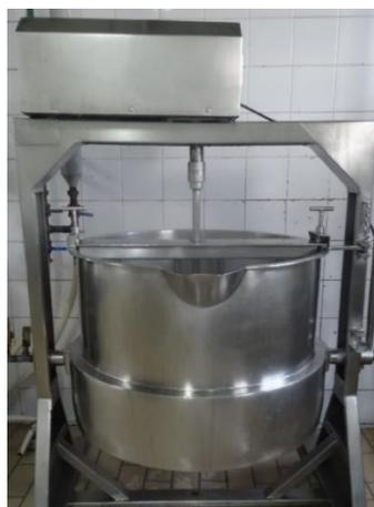
Figura 3.12. Tacho de filagem de mussarela da fábrica estudada.
