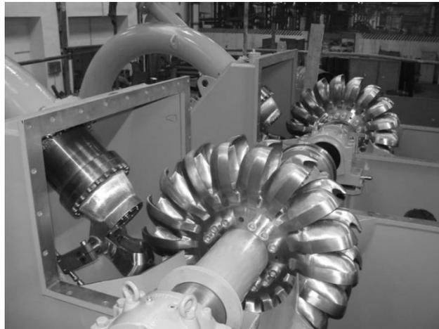
Figura 6. Turbina Pelton de pequeno porte e eixo horizontal (HYDROLINK, s/d).
