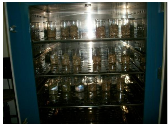
Figuras 4.34 e 4.35 - Detalhes da biomassa recém colhida antes da determinação do teor de umidade
