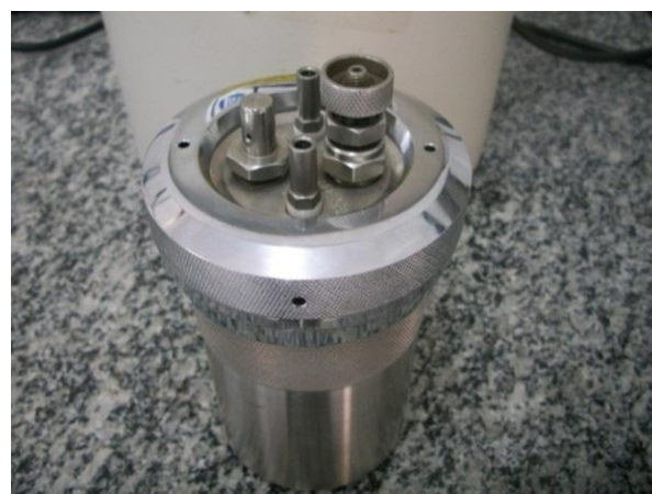
Figuras 4.66 e 4.67 - Detalhes dos cadinhos e da bomba calorimétrica utilizada para realização de medidas de PCS
