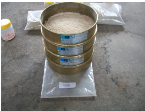
Figuras 4.58 e 4.59 - Preparação das amostras e realização de medidas de PCS
