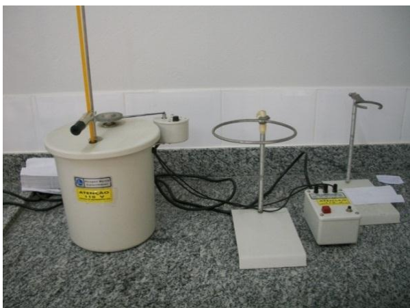
Figuras 4.64 e 4.65 - Bomba calorimétrica utilizada para realização de medidas de PCS
