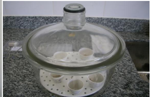
Figuras 4.60 e 4.61 - Equipamentos utilizados na secagem das amostras para realização de medidas de PCS
