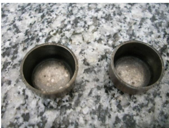
Figuras 4.66 e 4.67 - Detalhes dos cadinhos e da bomba calorimétrica utilizada para realização de medidas de PCS
