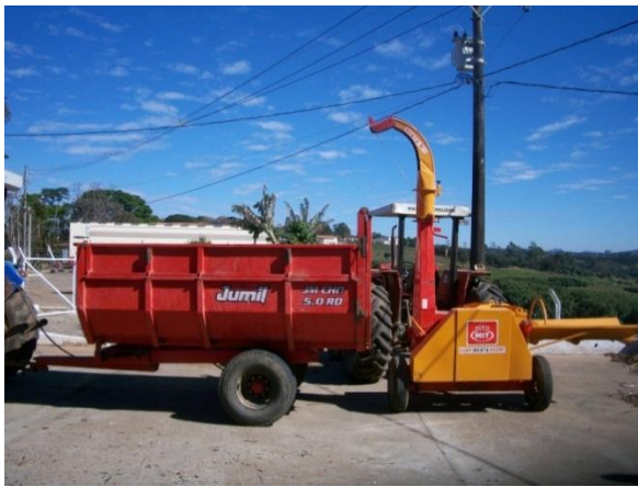
Figuras 4.42 e 4.43 - Detalhes do equipamento utilizado para picar a biomassa com a carreta
