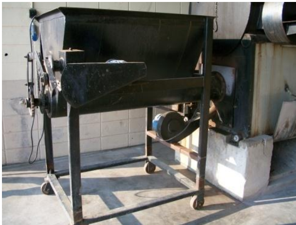
Figuras 4.82 e 4.83 - Sistema de alimentação de biomassa para a caldeira
