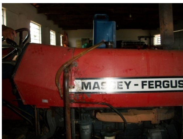
Figuras 4.38 e 4.39 - Detalhes do sistema de medição de consumo de diesel para picar a biomassa
