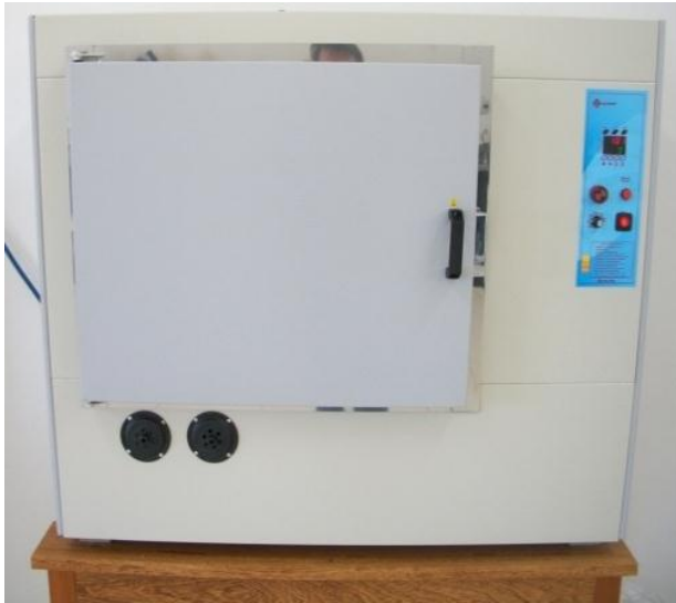
Figuras 4.60 e 4.61 - Equipamentos utilizados na secagem das amostras para realização de medidas de PCS
