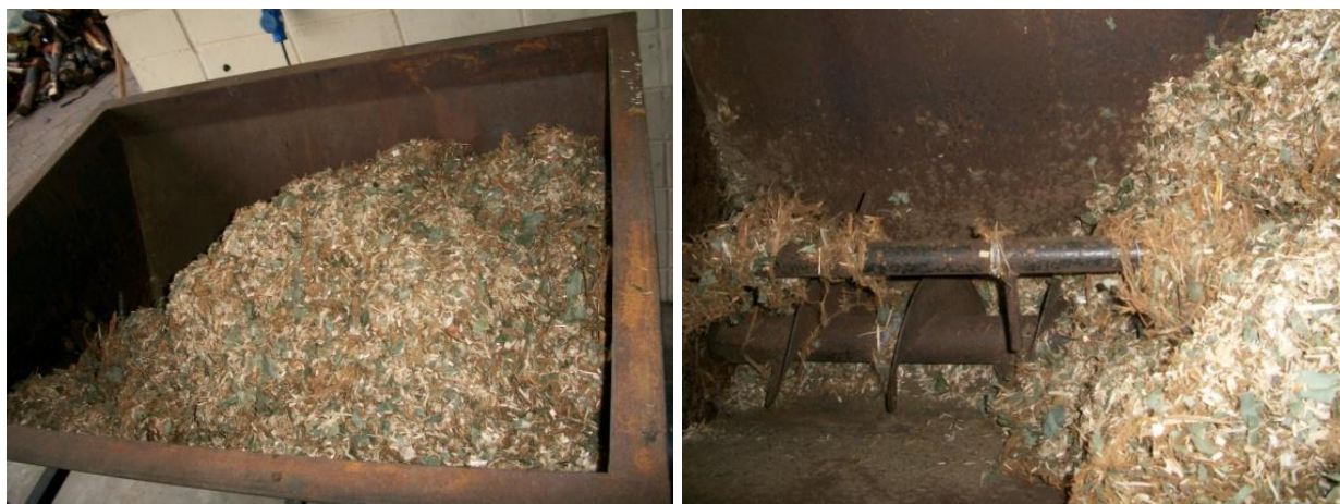
Figuras 4.91 e 4.92 - Detalhes do sistema de silo e da rosca de alimentação de biomassa operando com eucalipto E. urophylla picado
