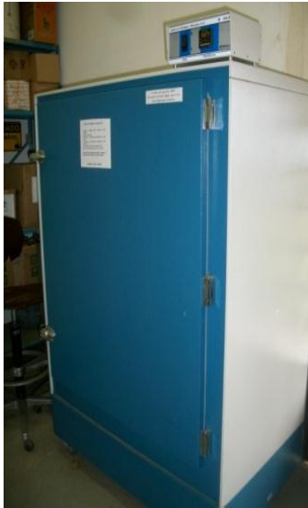
Figuras 4.36 e 4.37 - Detalhes da estufa utilizada na secagem
