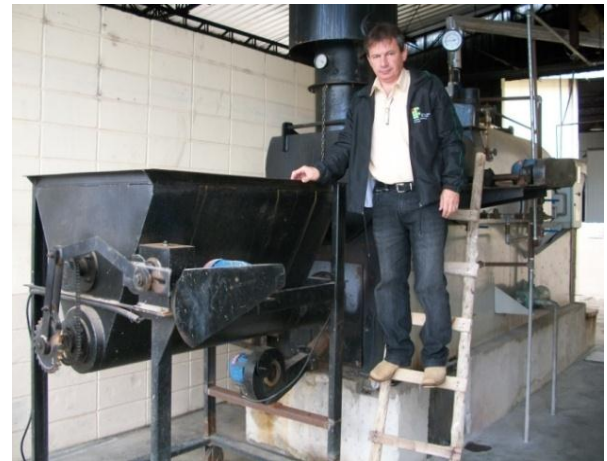
Figuras 4.82 e 4.83 - Sistema de alimentação de biomassa para a caldeira
