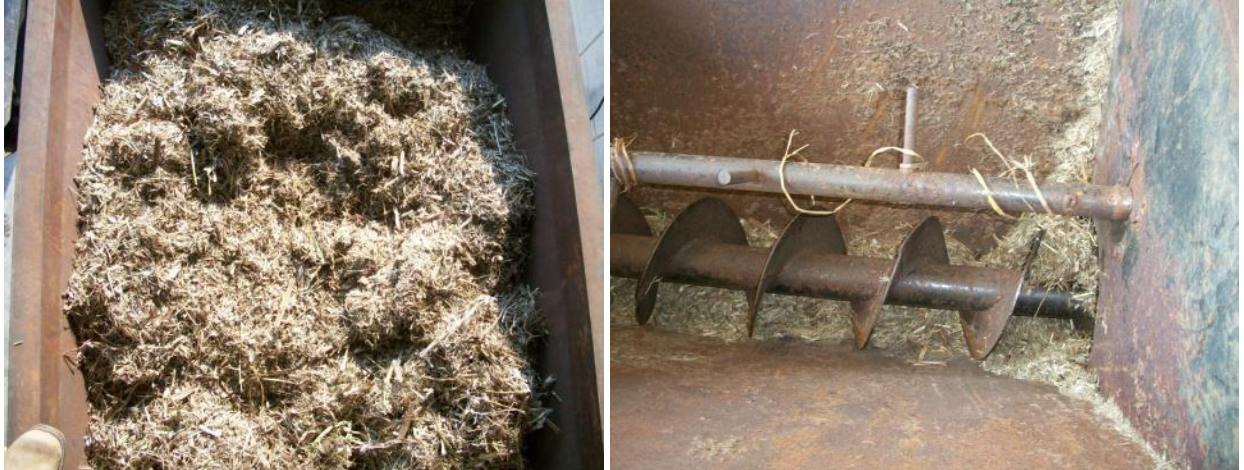
Figuras 4.86 e 4.87 - Detalhes do sistema de silo e da rosca de alimentação de biomassa operando com capim elefante “Napier” picado
