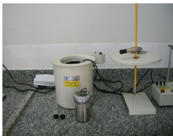
Figuras 4.64 e 4.65 - Bomba calorimétrica utilizada para realização de medidas de PCS
