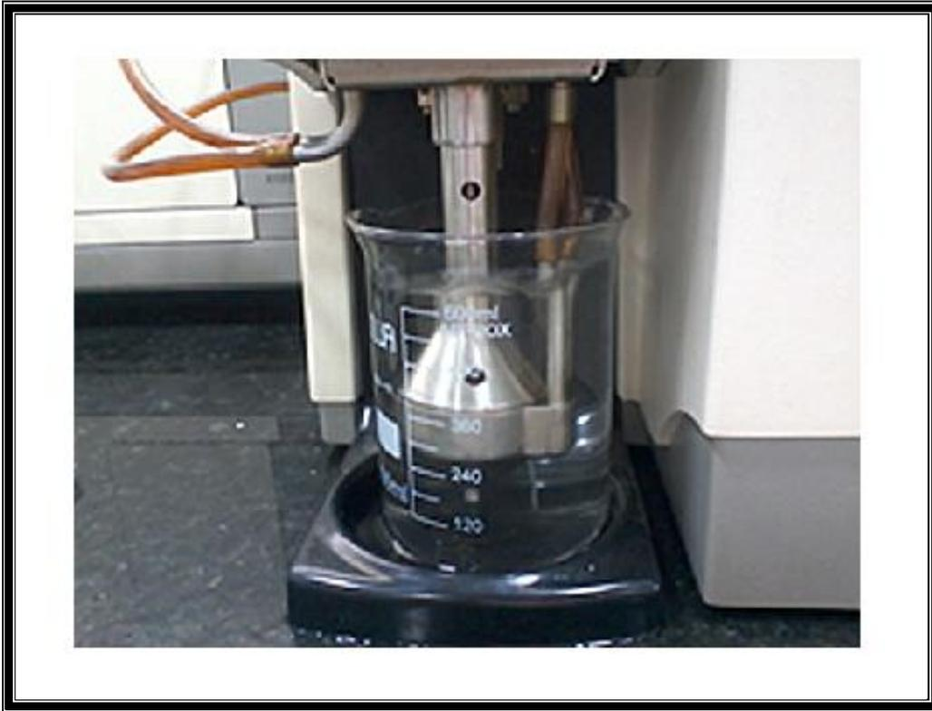
*Figura 3 7: Equipamento Malvern para análise do tamanho das partículas de negro de fumo por difração a laser.*
