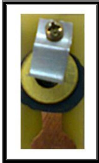
*Figura 3.3: Amostra sobre a placa de circuito impresso com o contato mecânico.*
