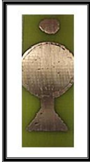
*Figura 3.1: Placa de circuito impresso corroída por percloroeto de ferro pronta para a deposição da tinta.*
