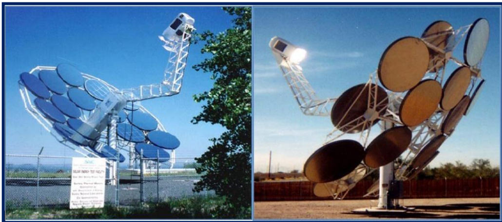
Figura 2.21 Protótipo construído pela SAIC e STM “Sistema Disco-Stirling fase 1 e fase 2”. (SANDIA, 2001)
