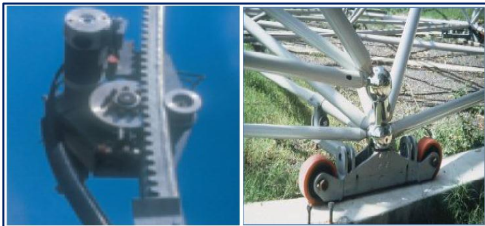
Figura 2.8 Sistema de controle para um sistema Dish/Stirling (Burgess, 2006)
