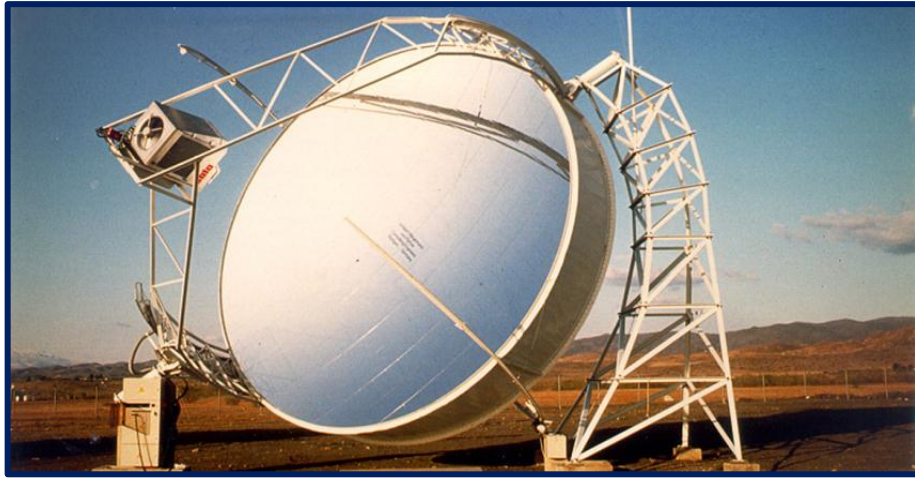
Figura 2.18 Distal I coletor solar de membrana esticada (CIEMAT, 2009)
