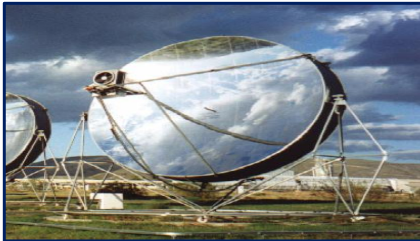
Figura 2.16 Sistemas Concentrador/Stirling fabricado por SBP 1989 (Geyer, 2007)
