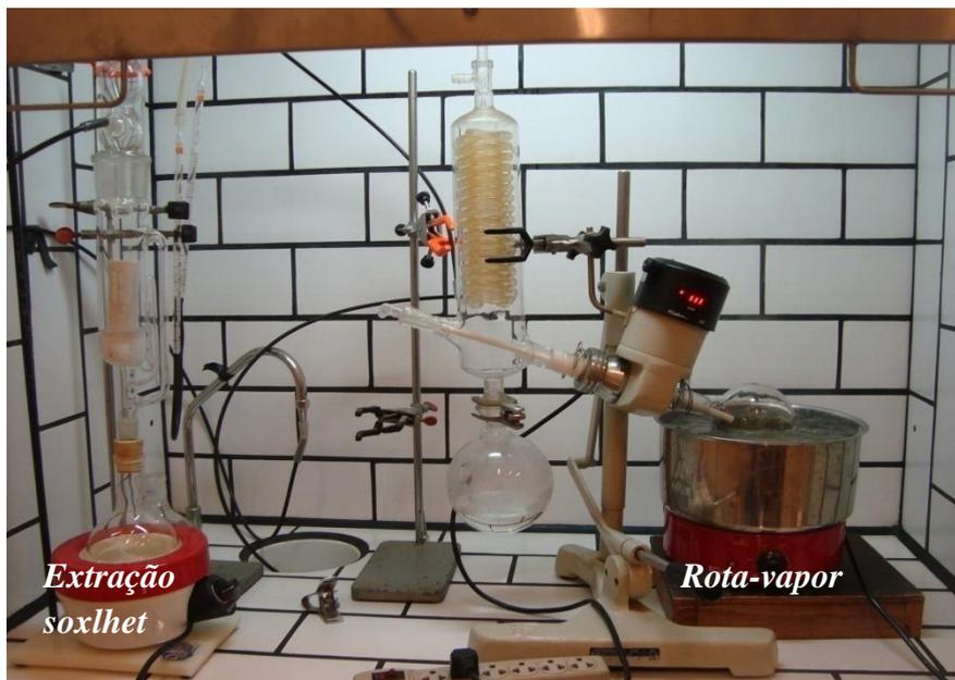
Figura 3.7. Sistema de extração soxhlet e Rota-vapor
