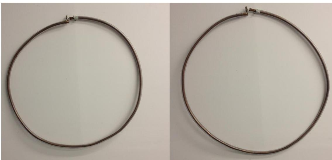
**Figura 4.24** – Antenas quadro L1 e L2 confeccionadas , 33cm de raio e diâmetro do condutor de 10mm.
