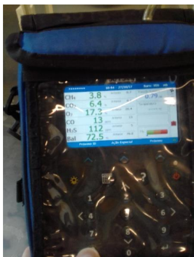
Figura 18. Aparelho Geotech ®, aferidor da composição do biogás. Fonte: acervo do autor.
