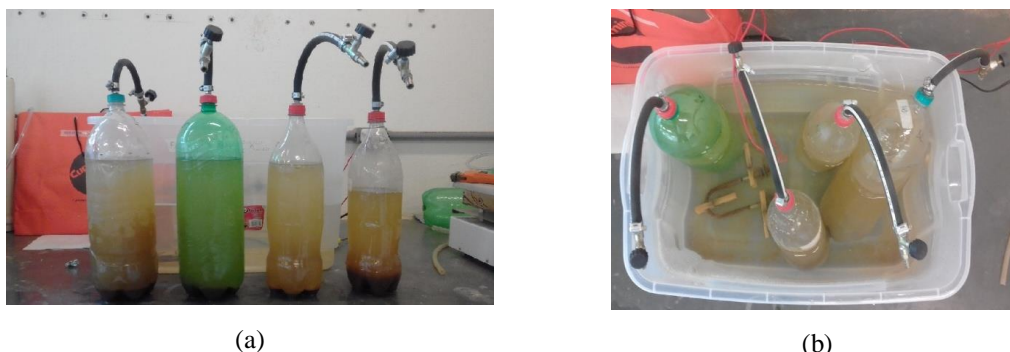
Figura 20. Biodigestores A1, A2, A3 e A4 (a) e vista superior dos biodigestores no sistema (b).
