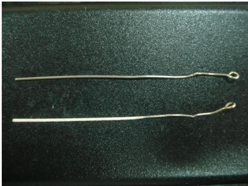
Figura E.20 – Fotografia de dois fios de platina, um sem hidrogel e outro com hidrogel  $\text{pHEMA}^{\text{KCl}}$  aderido no fio. (Fonte: próprio autor)
