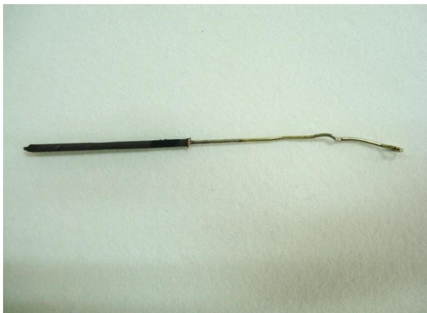
Figura E.21 – Fotografia do hidrogel eletroativo  $\text{pHEMA}^{\text{KCl}}/\text{PANI.CSA}$  aderido no fio de platina. (Fonte: próprio autor)
