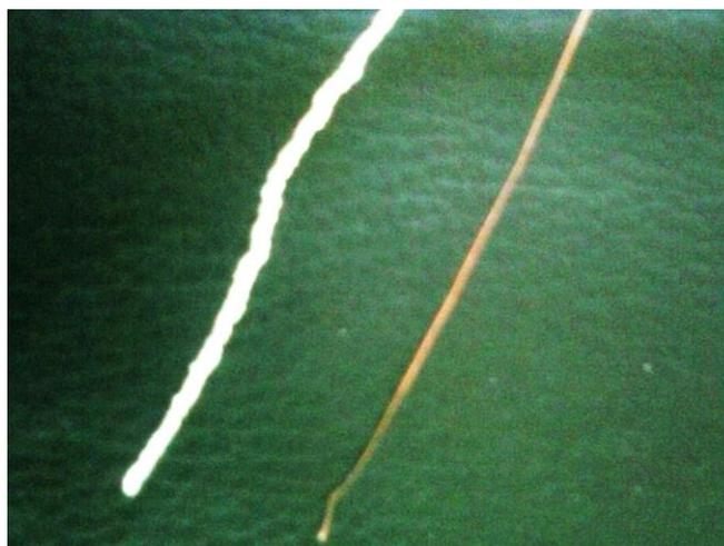
Figura. C.8 - Foto da comparação do fio de cobre puro e do fio de cobre coberto pelo polímero pHEMA<sup>APS</sup>. O que demonstra a aderência do polímero na superfície do metal.
