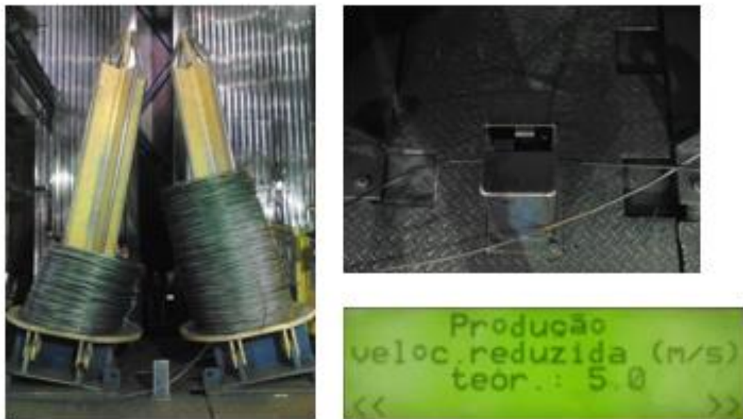
Figura 56: Instrumentação para automatizar passagem de solda [Autor]
