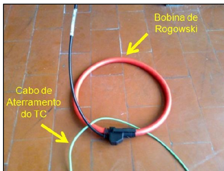
Figura 4.23 - Bobina de Rogowski sob ensaio em laboratório.
