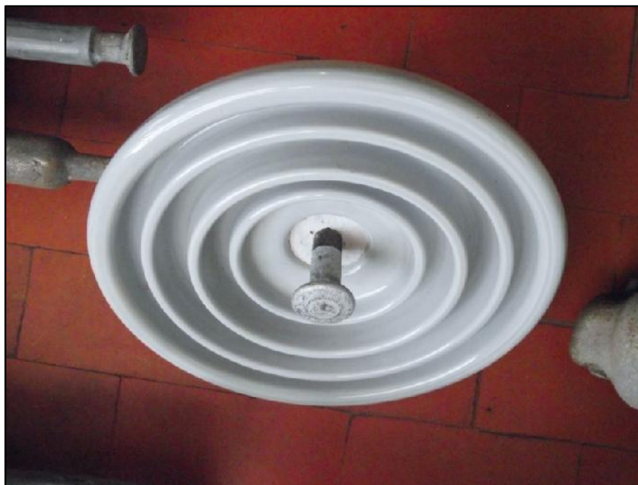
Figura 2.3 - Exemplo de isolador de disco de porcelana - vista inferior.
