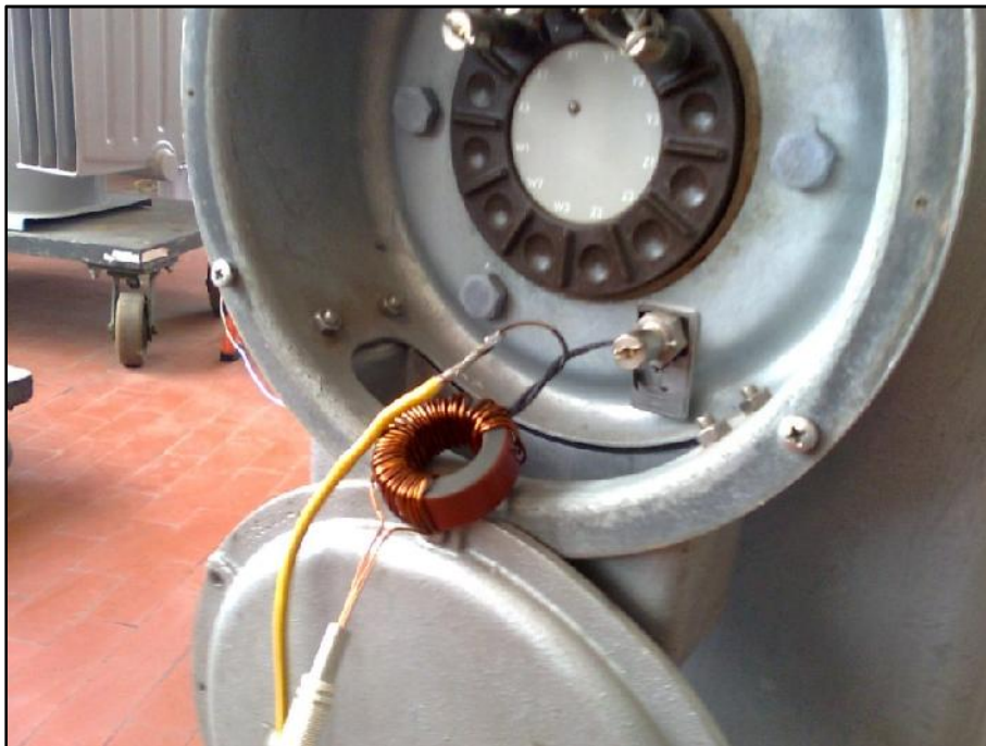
Figura 4.32 - Sensor de corrente montado com o núcleo MM002T4416 sob ensaio na linha de transmissão artificial.
