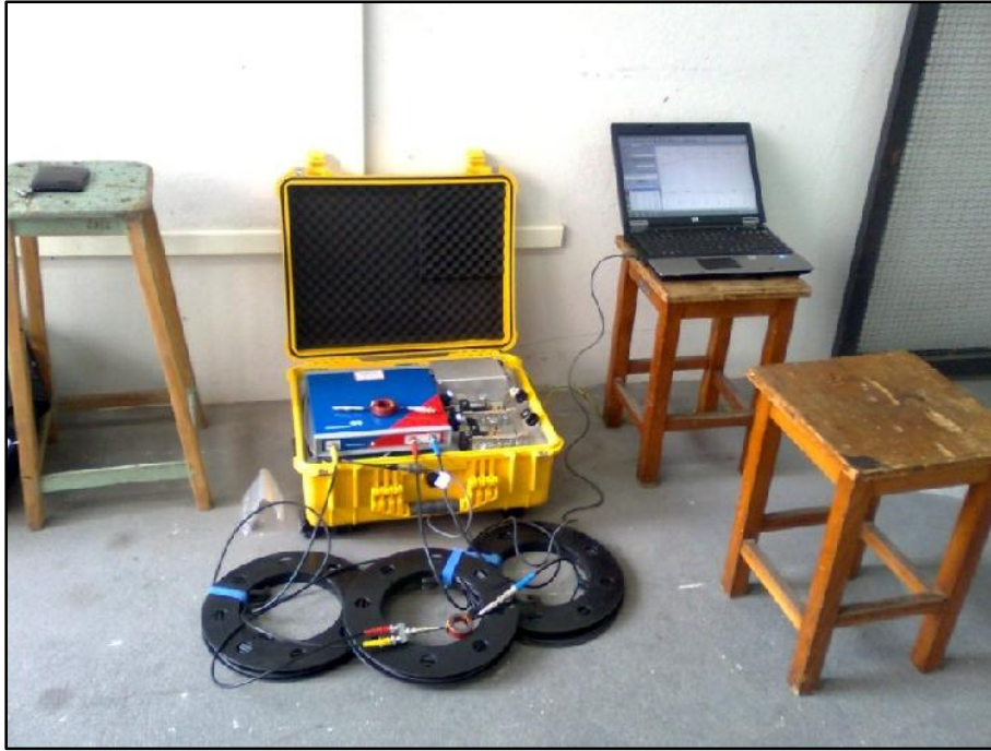
Figura 4.31 - Sensor de corrente sob ensaio de resposta em frequência com o uso do FRAnalyzer®.
