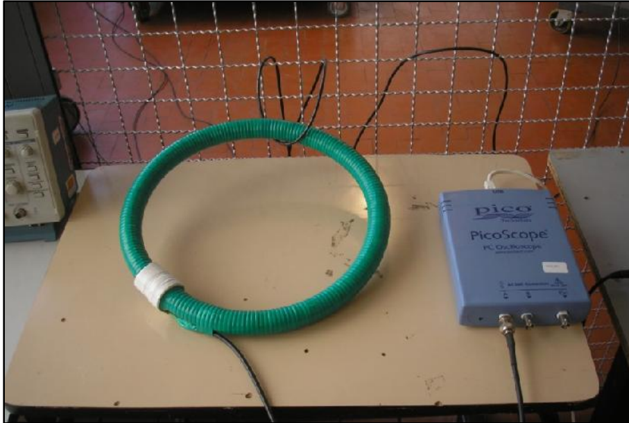
Figura 4.25 - Bobina de Rogowski desenvolvida em laboratório.
