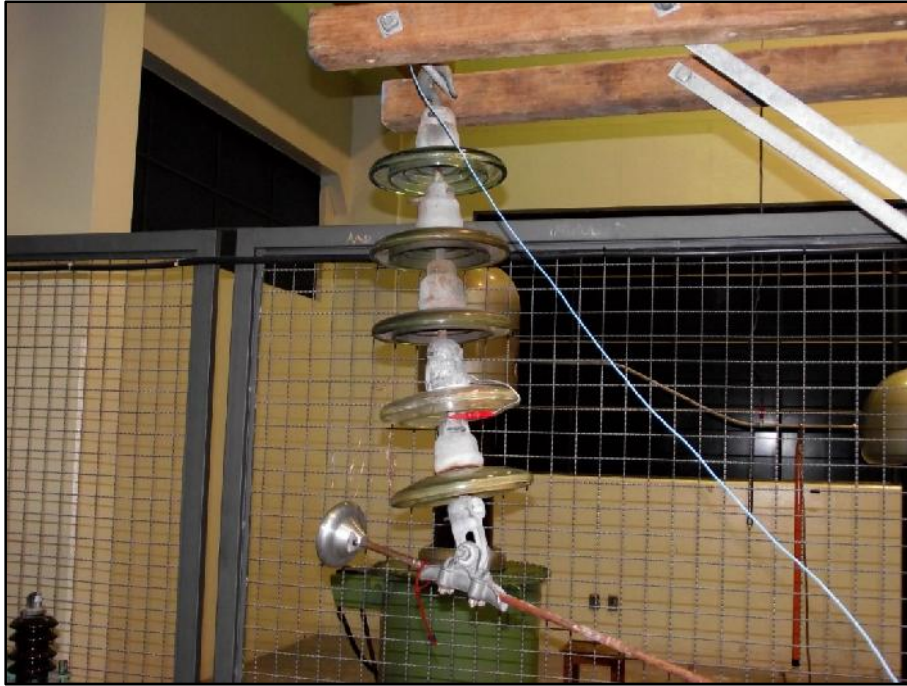
Figura 4.19 - Cadeia de isoladores de vidro utilizada no ensaio, dotada de dispositivo de simulação de descargas parciais no segundo isolador (contando a partir da fase).
