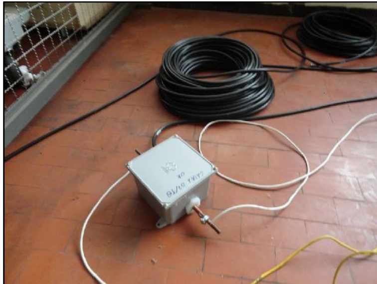
Figura 4.37 - Lance de cabo RG213 sob ensaio no LAT-EFEI.
