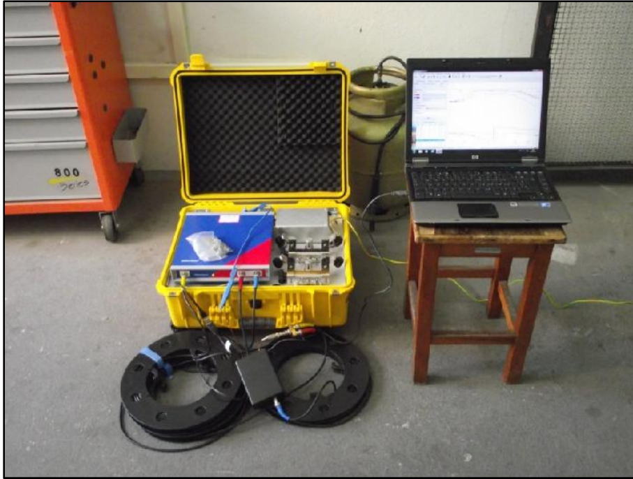
Figura 4.33 - Protótipo da caixa de aquisição sob ensaio de resposta em frequência.
