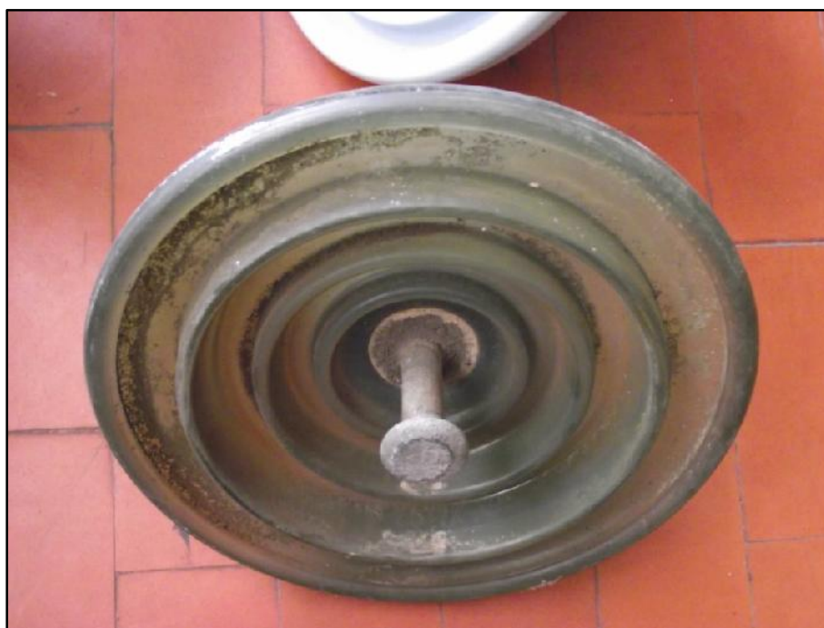
Figura 2.10 - Exemplo de isolador de disco contaminado na região das saias internas.
