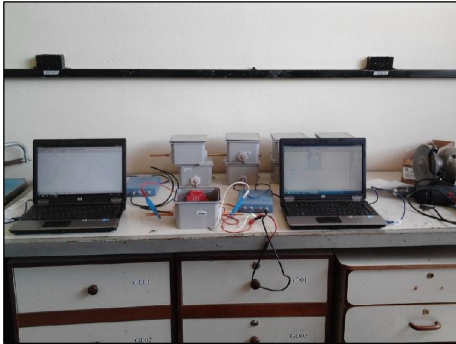
Figura 4.36 - Caixas de aquisição sob ensaio no LAT-EFEI.
