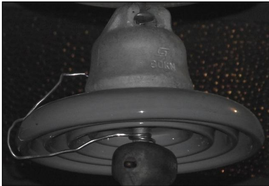
Figura 3.2 - Dispositivo de simulação de descargas parciais acoplado à um dos isoladores da cadeia. (Capelini, 2011).
