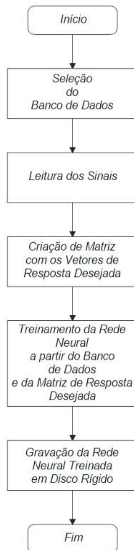
Figura 4.50 - Fluxograma do algoritmo de treinamento.
